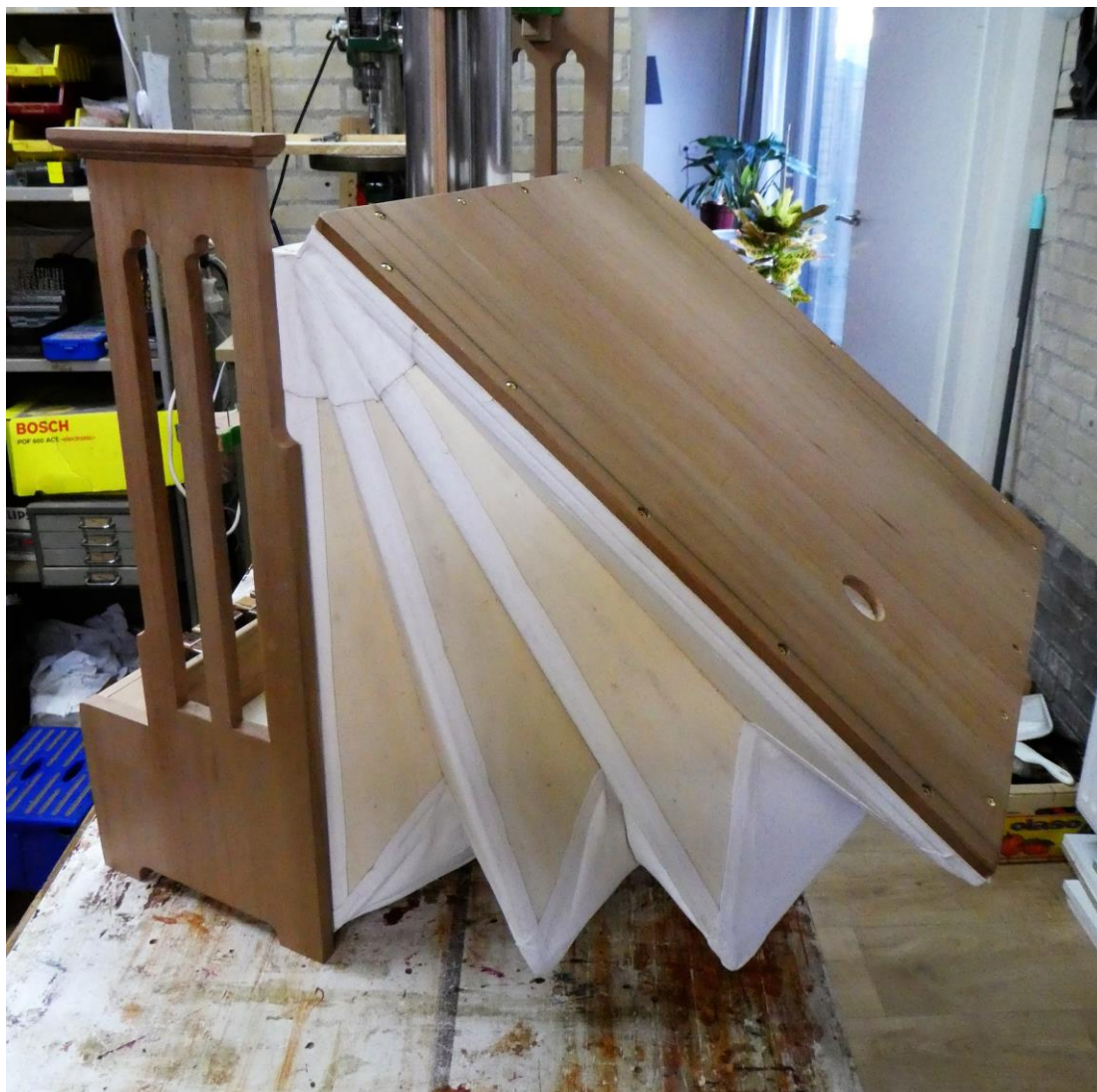
Balg is klaar om te testen!
