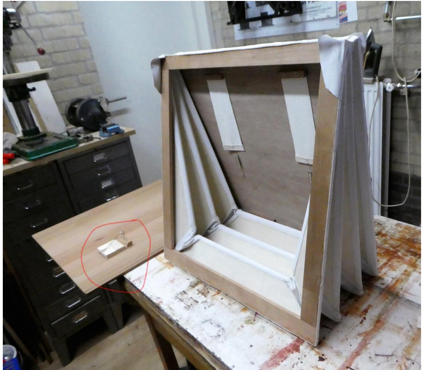
In de achterkant is een loosklepje aangebracht.
