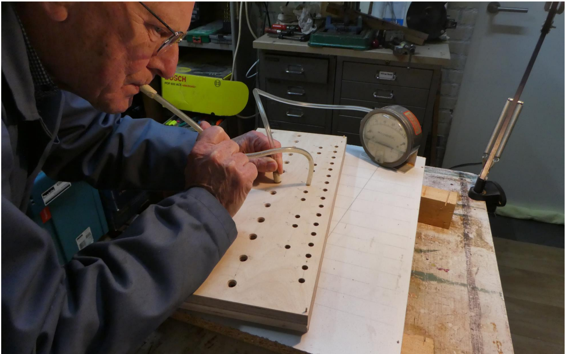
Controle op lekkage naar naastgelegen gaten.
