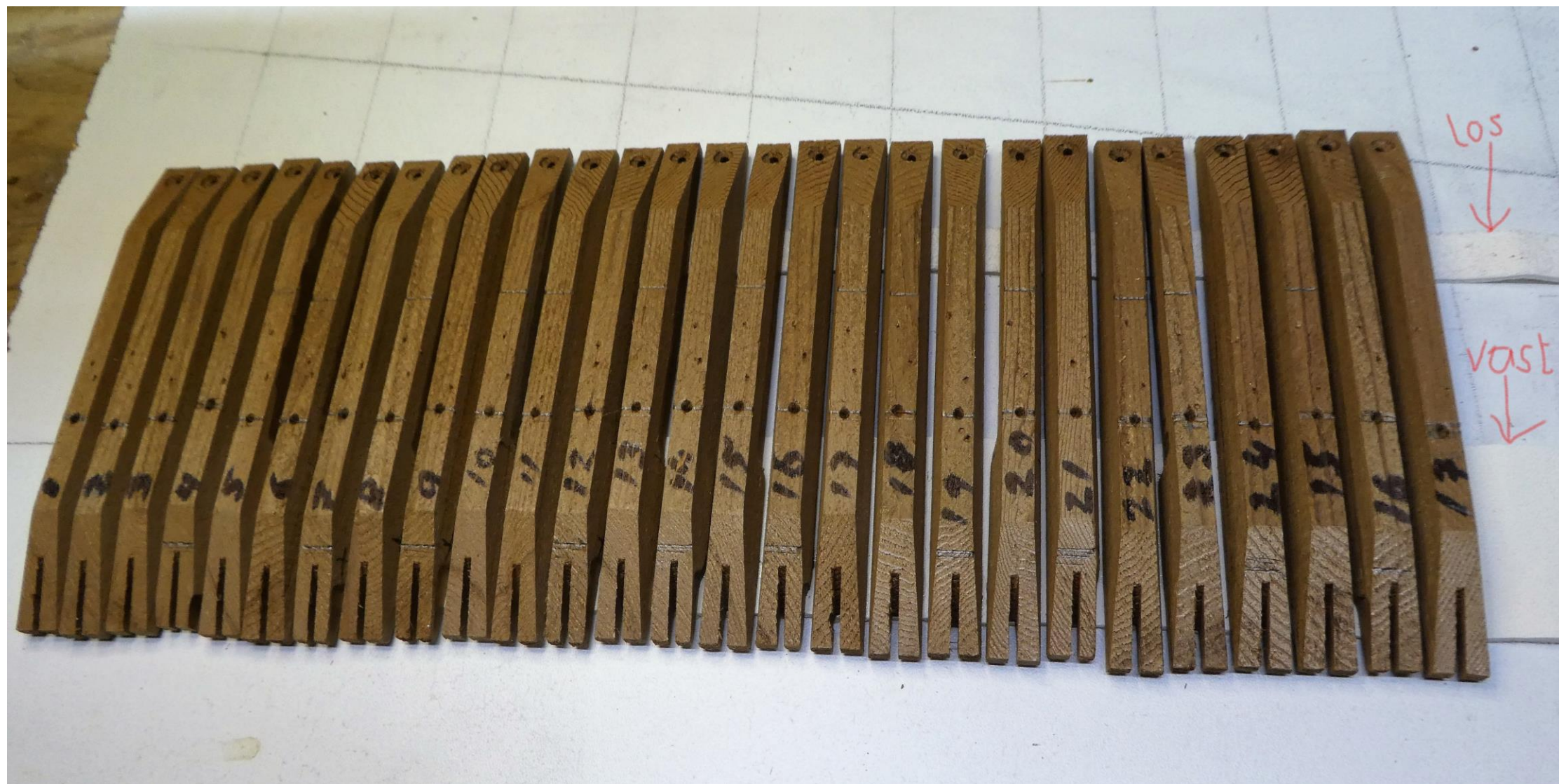
Kleppen op een strook leer geplakt. De bovenste reep is 'dikte compensatie' bij het aandrukken.
